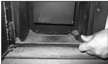
Ábra 12. A csőköteges hőcserélő kitakarítása az égő alatta lévő revíziós nyílásról elvégezhető. (modell 13 Kw)
