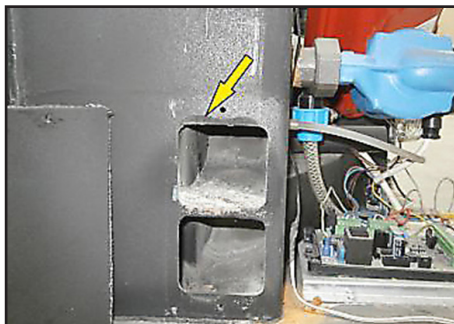
Ábra 11. A korom lepedék kitalarítása az ellenőrző nyílások keresztül a kandalló két oldalon – 2. lépés (modell 18 Kw-25kW)
