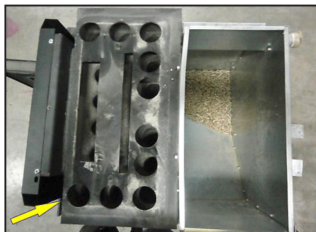
Ábra 8. A vízszintes füstnyílások a fedő leszerelése - 2
